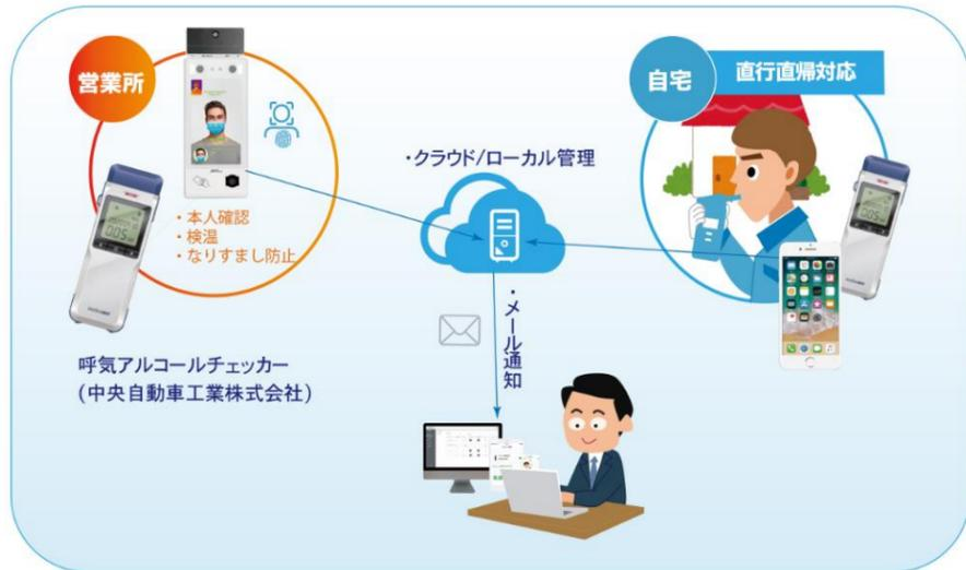
安全運転管理者と運転者の手間を削減する**アルコールチェックシステム「Ai-RollCall」**はアルコールチェックと体表面温度測定機能付き顔認証タブレットを組み合わせたシステムです。顔認証タブレットに事前に個人の登録をすることで、アルコール検知器の測定結果と測定時の顔写真、体温等をクラウドやローカルサーバーに格納します。ドライバーが直行直帰する際は、専用のスマートフォンアプリを用いて遠隔でアルコールチェックの結果を送信することができます。
